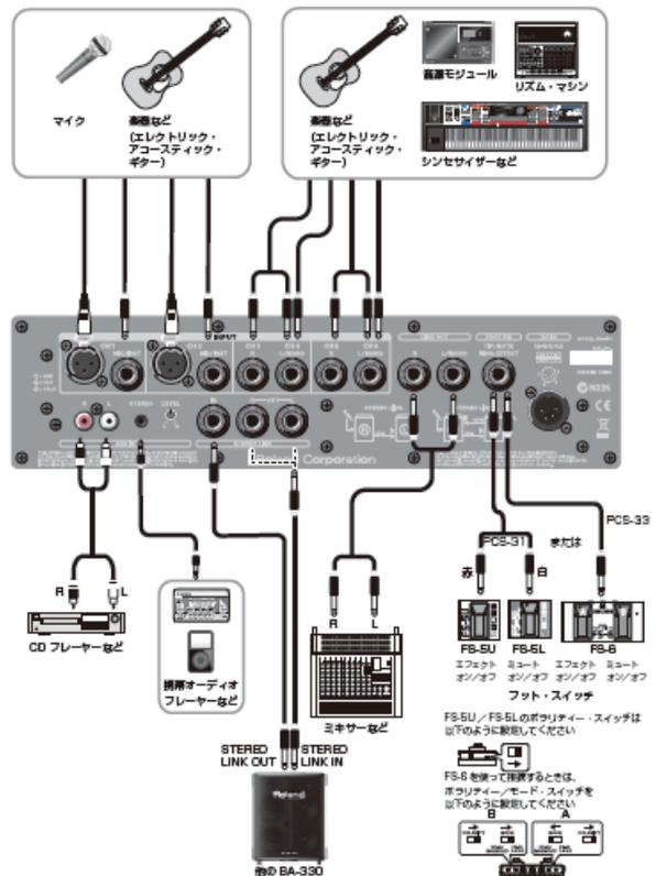
新規入りの接続ケーブルを使用すると、INPUTに接続した機器の音量が小さくなる場合があります。
