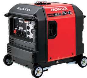
インバーター発電機 ▶ EU-24i / HONDA 2.4kVA 定格負荷連続運転: 8時間 外形寸法: W655×H555×D455mm タンク容量: 12L 54kg
