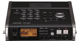
MP3HDDレコーダー&プレーヤー ▶DR-680 / TASCAM Rec Ch数：6ch Rec Format：WAV,BWF,MP3 入力端子：XLR
